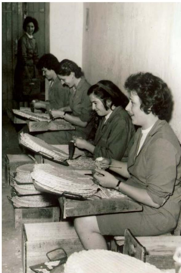
Particolare del reparto delle taglierine addette alla produzione delle tessere mediante il taglio delle pizze di vetro uscite dagli altiforni.
