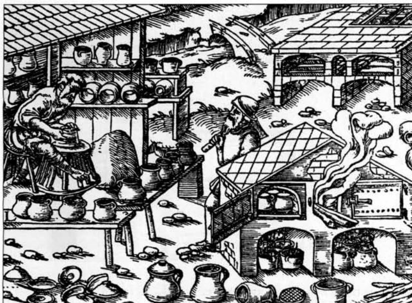
Lavoro al tornio e cottura in una fornace nel Cinquecento. (da G. Agricola, De re metallica XII libri, Basilea, 1556, copia anast. New York, 1950).
